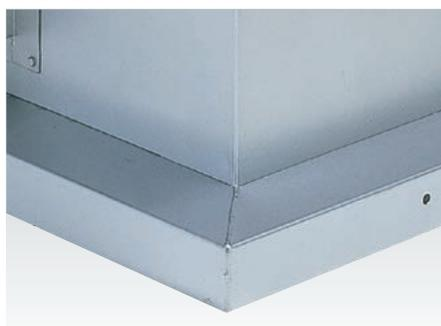
鋼板製造工程の中で特殊亜鉛メッキ層を亜鉛-鉄合金に変成させたものです。普通鋼板と比較すると、耐食性に優れ、かつ塗装の密着性がよいなどの特長を持つ高級材料です。塗装は、標準仕様の場合、アクリル樹脂系塗装仕上げを行います。耐塩用にアクリルウレタン樹脂系塗装仕上げもあります。
