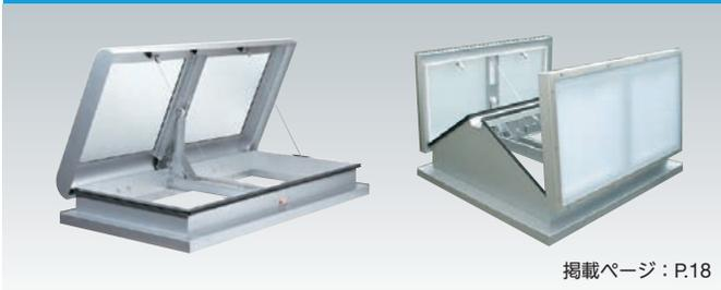
結露を防止するポリカーボネート(中空シート)を採光部に採用。普通ガラスの450倍、アクリルの約30倍の耐衝撃性があり、耐熱、耐寒性も保持。耐候性に優れ、幅広い用途に応えます。
